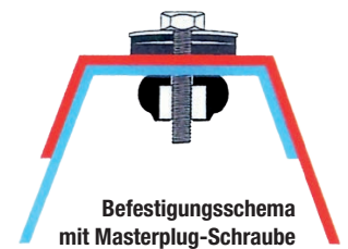
Zu Abb. 4 Masterplugschraube 9,5 mm Durchmesser, vorbohren mit 14 mm Bohrer
